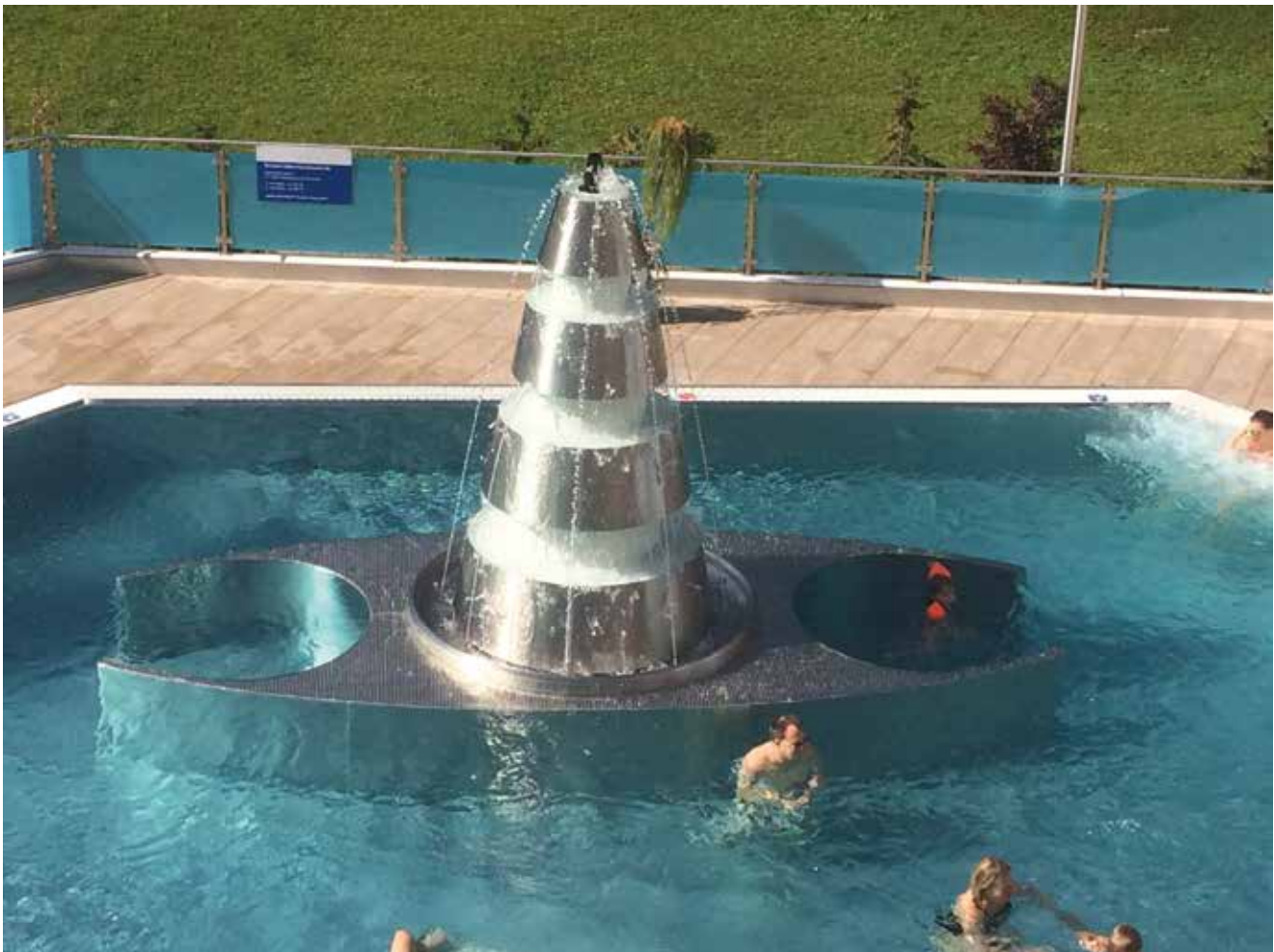
Bild 4: Wasserattraktionen erhöhen die Aerosolbildung, so dass auch in Freibädern mit einer stärkeren Chloridbelastung zu rechnen ist
